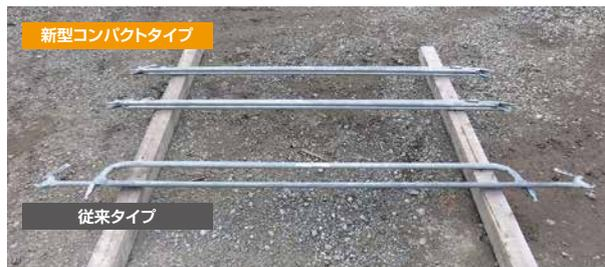
手すりとブレースを同じ長さにするにより、3本が隙間なく一体化
